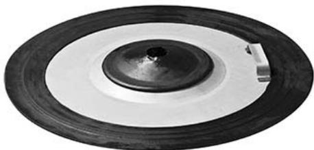
Plato seguidor estándar para latas de 12,5 kg a 18 kg, 260-298 mm. Los platos seguidores eliminan las bolsas de aire y ayudan al cebado de la bomba. La brida de goma minimiza el desperdicio de material. Incluye asa para sacar el plato de los bidones vacíos. Adecuado para latas de 12,5 a 18 kg, de 260-298 mm ext. Ø (mín. - máx.).
